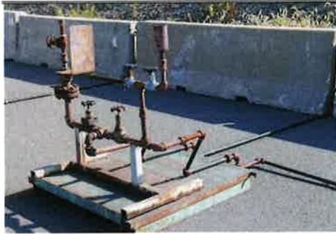
Alimentación de propano a practica de extintores, las practicas estarán sobre un bastidor para poder moverlas con una carretilla una vez desconectado el gas.
