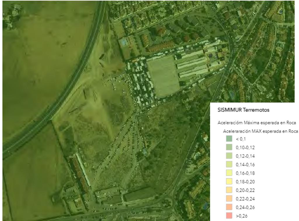
**Figura 8.** PGA (aceleración máxima de movimiento en roca) esperada
