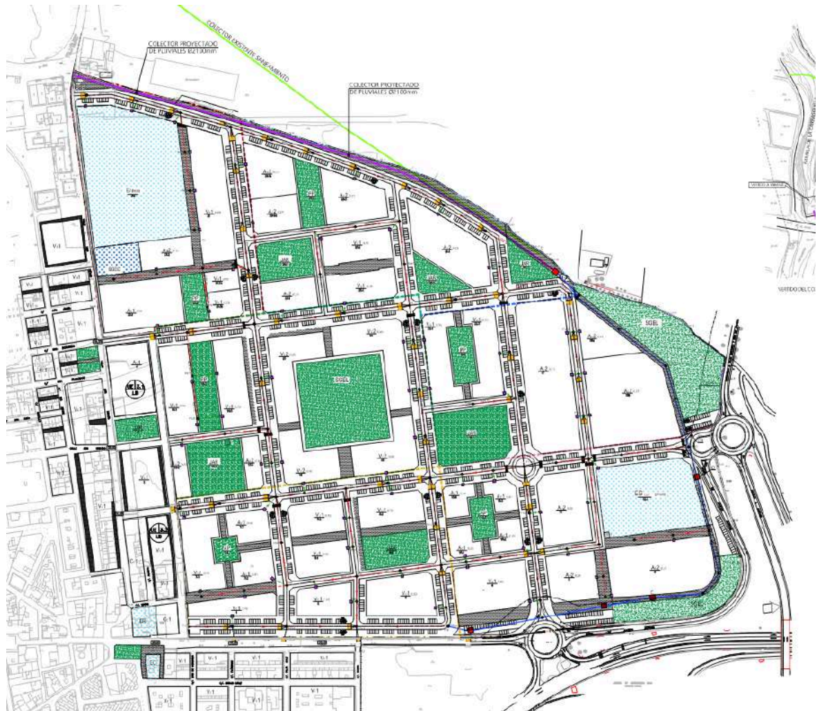
Imagen 3. Red de pluviales
