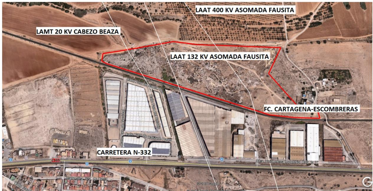
Por otro lado, existen dos líneas aéreas de alta tensión (LAAT) de 132 kV y 400 kV que atraviesan la parcela de Norte a Sur. La línea de 20 kV del Cabezo Beaza,
