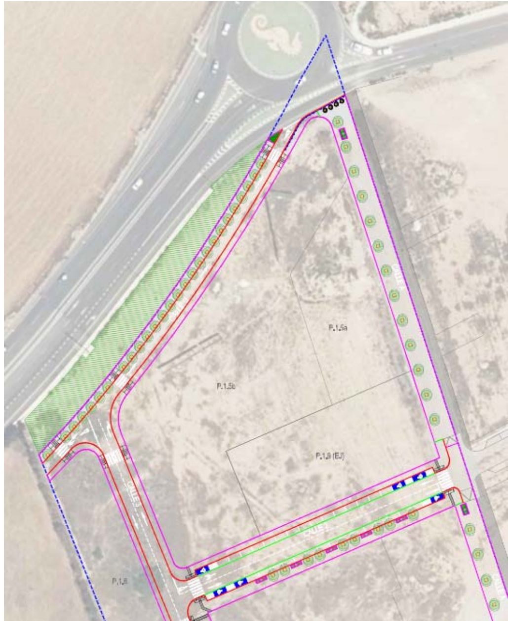
FIGURA 2. SITUACIÓN INICIAL. CONEXIÓN DE LA CALLE G CON EL VIARIO EXTERIOR POR EL NORTE Y CALLE A CONFIGURADA DE PLATAFORMA ÚNICA, SIN APARCAMIENTOS Y SIN ACCESO DE ENTRADA POR EL NORTE DEL SECTOR
